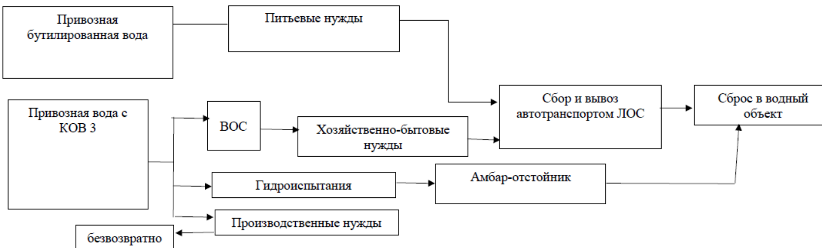
Рисунок 3.3-1. Укрупненная схема водопотребления и водоотведения на период строительства. Северный купол
