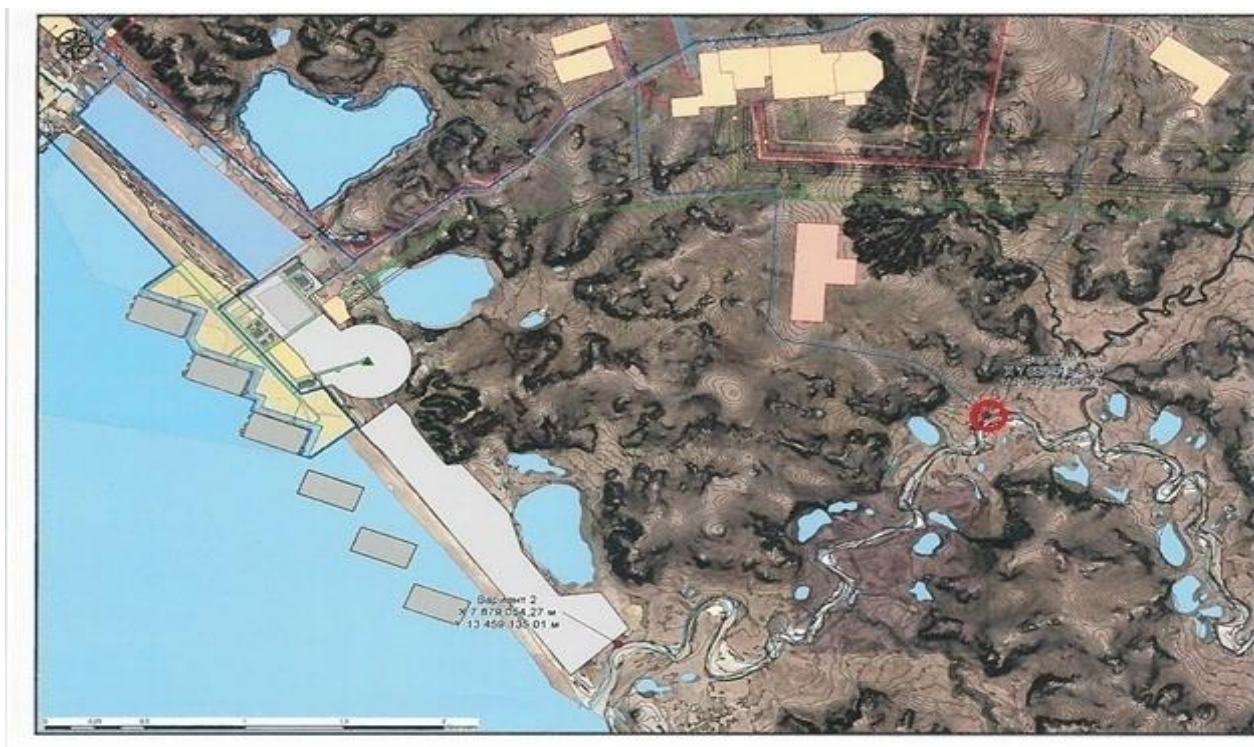
Рисунок 5.1-2. Схема расположения сброса очищенных хозбытовых сточных вод в период строительства в р. Нядай-Пынче
