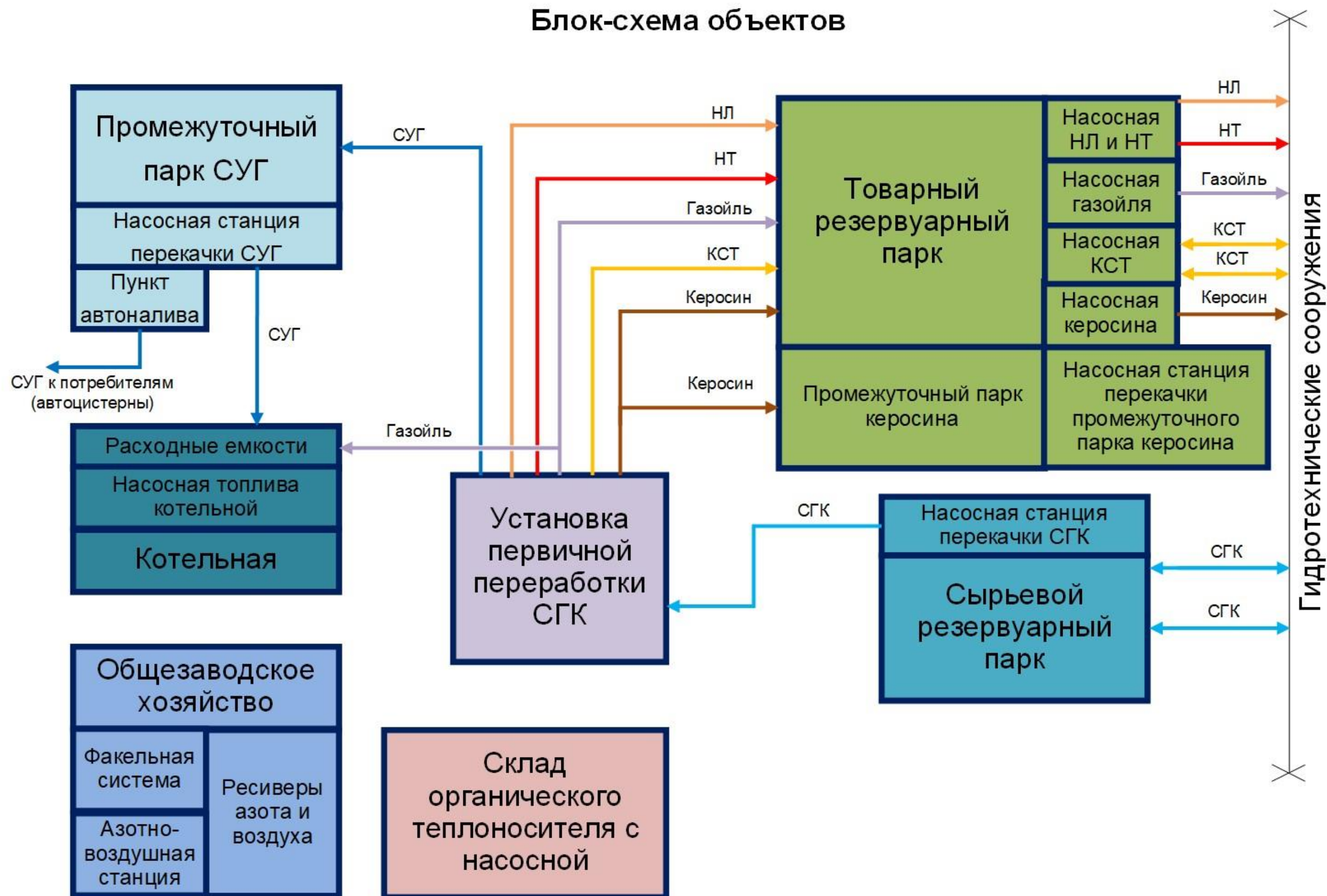
Рисунок 1.3.1 - Принципиальная схема технологических объектов терминала
